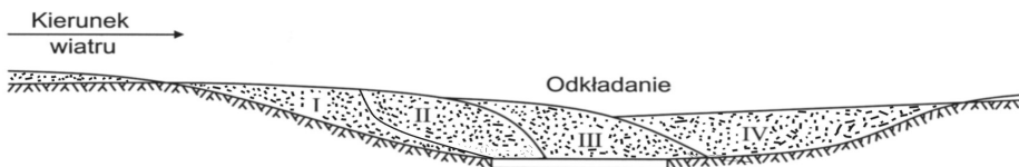
Rys.4. Nawiewanie i odkładanie się śniegu na drogę w wykopie
